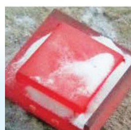
Образцы после высокотемпературного теста на эрозионный износ
